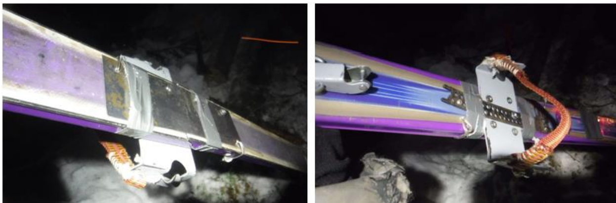
Фото 22. Ремонт сломанной пластиковой лыжи.
